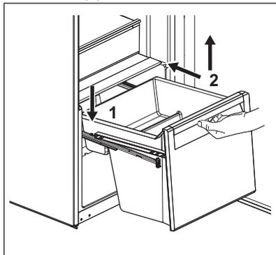
3. Heben Sie den vorderen Teil der Schublade (2) an, während Sie sie hineinschieben.
