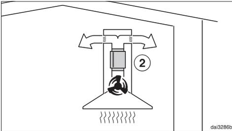
Der Schalldämpfer wird zwischen Ausblasstutzen und Umlenkweiche positioniert ②. Der Einbauraum ist im Einzelfall zu prüfen.
