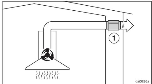
Der Schalldämpfer dämpft sowohl Gebläsegeräusche nach außen als auch Außengeräusche, die über die Abluftleitung in die Küche dringen (z. B. Straßenlärm). Dazu wird der Schalldämpfer möglichst nah vor dem Abluftaustritt ① positioniert.
