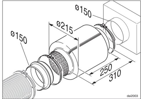
In die Abluftleitung kann ein Schalldämpfer eingesetzt werden (nachkaufbares Zubehör). Er dient zur zusätzlichen Geräuschdämpfung.
