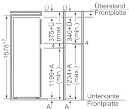
Die angegebenen Möbeltürmaße gelten für eine Türfuge von 4mm. Bei Verwendung einer anderen Fugenbreite (max. 14 mm) müssen die Maße angepaßt werden. Maße in mm
