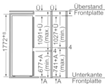
Bei größeren Maßen (1780 - 1790) muss an der Nischendecke eine Distanzleiste vorgesehen werden. Die angegebenen Möbelmaße gelten für eine Türfuge von 4mm. Bei Verwendung einer anderen Fugenbreite (max. 14mm) müssen die Maße angepaßt werden.
