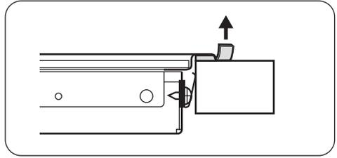
Placez la table de cuisson dans la découpe et poussez-la jusqu'à ce qu'elle soit en contact avec le plan de travail, puis enlevez le surplus de joint d'étanchéité.
