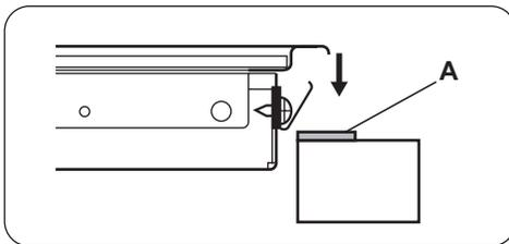
Collocare la guarnizione di tenuta A tutt'attorno al bordo dell'incasso.
