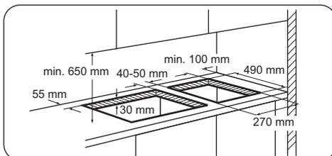
Se devono essere installati diversi piani di cottura di 30 cm fianco a fianco nello stesso incasso, presso i nostri Centri di Assistenza autorizzati sono disponibili: un kit di assemblaggio che include una staffa di supporto laterale e guarnizioni supplementari. Le relative istruzioni di installazione vengono fornite assieme al kit.
