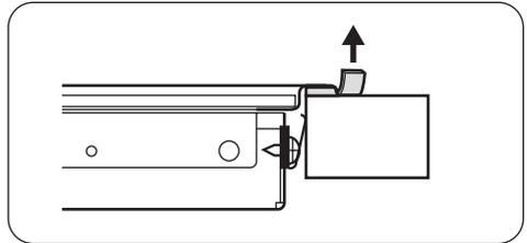
Montare il piano di cottura nell'incasso e spingerlo in basso finché non viene a contatto con la superficie superiore della cucina, quindi rimuovere la guarnizione in eccesso.
