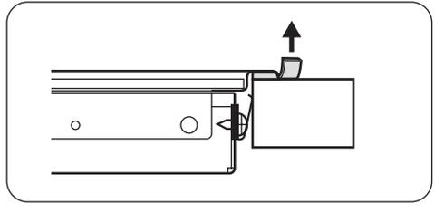
Setzen Sie das Kochfeld in die Aussparung und drücken Sie es nach unten, bis es die Arbeitsplatte berührt. Entfernen Sie dann die überschüssige Dichtung.
