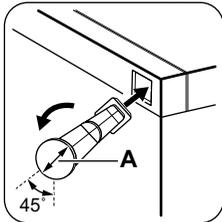
2. Drehen Sie die Distanzstücke um 45° nach links, bis sie einrasten.
