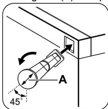
2. Rotiți distanțierele spre stânga la 45°, astfel încât să se fixeze.
