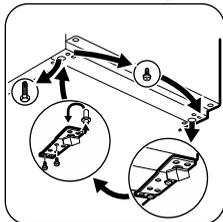
5. Desfaceți șurubul și montați-l pe partea opusă.
